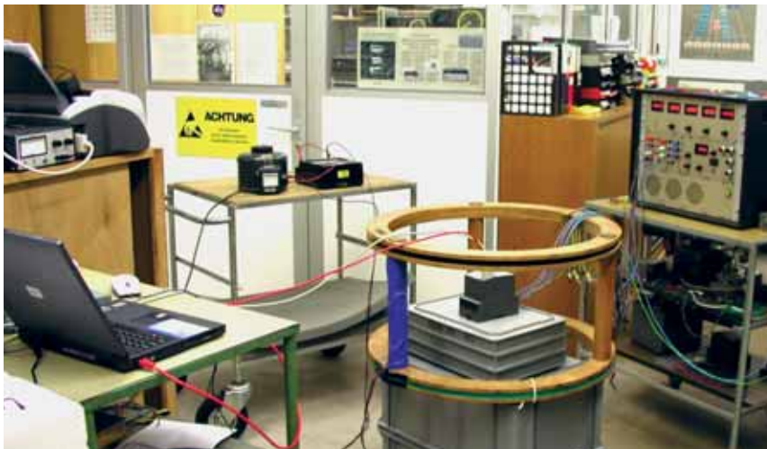
Ermittlung des Geräteverhaltens unter dem Einfluss eines magnetischen Fremdfeldes, welches mit einer Helmholtz-Spule erzeugt wird
