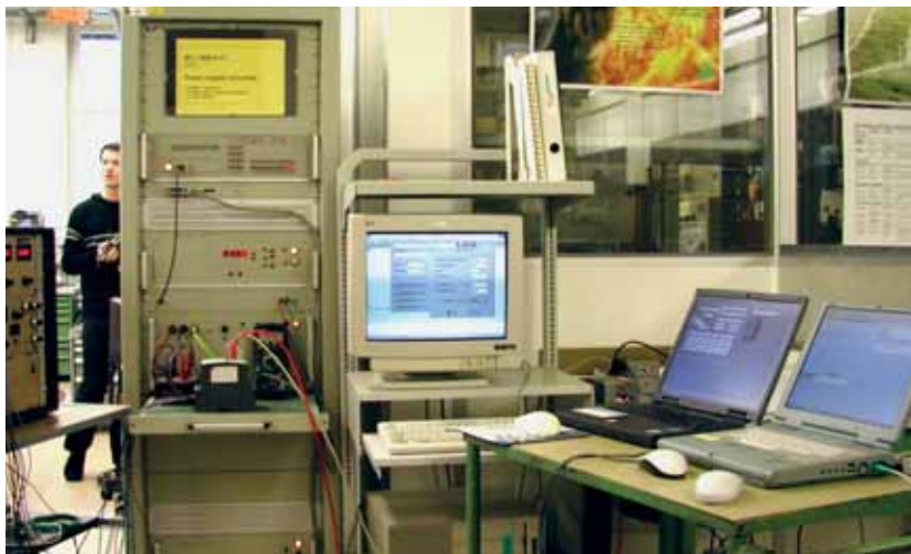
Messung des Verhaltens der Geräte bei Spannungseinbrüchen, Kurzzeitunterbrechungen oder Spannungsschwankungen der Hilfsenergieversorgung
